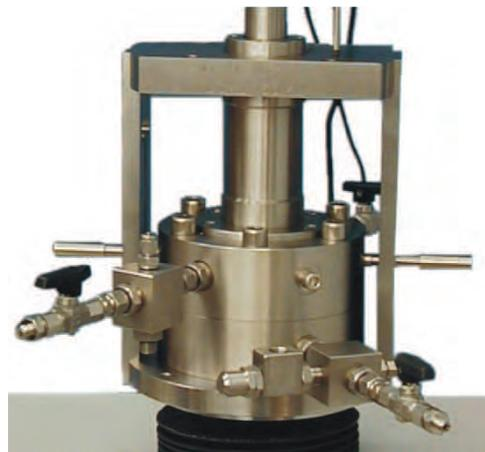
Fig. 1 Célula de Alta Presión (GDS CRS)
