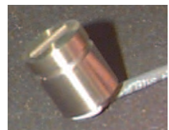
Fig. 1 Elemento Bender GDS, en titanio, en la cabeza de medida.
