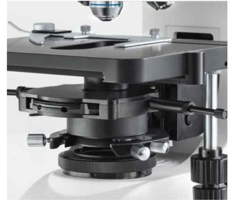
Condensador montado de contraste de fases
