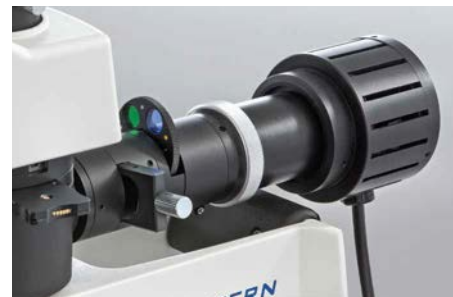
Unidad de iluminación con rueda de filtro
