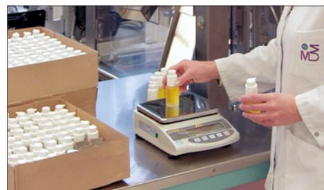
**Pesaje con rango de tolerancia (checkweighing):** Una señal óptica facilita el proceso de racionar, dosificar o clasificar
