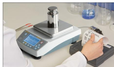
**Protocolización GLP/ISO** de datos de pesaje, alineación de balanzas, etc. con fecha, hora y nº de identificación. Ideal para la supervisión y documentación de sus procesos conforme a su sistema de control de calidad
